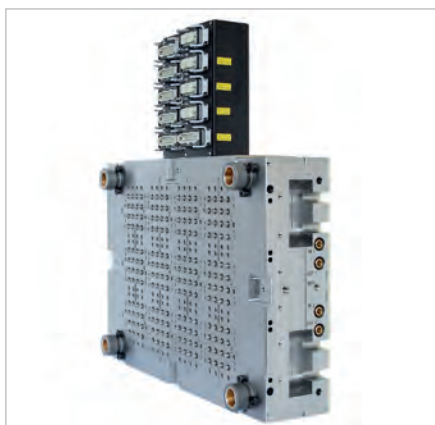
■ Progettazione compatta: stampo a 192 impronte (sinistra) micro-collettori e collettore principale (destra)
